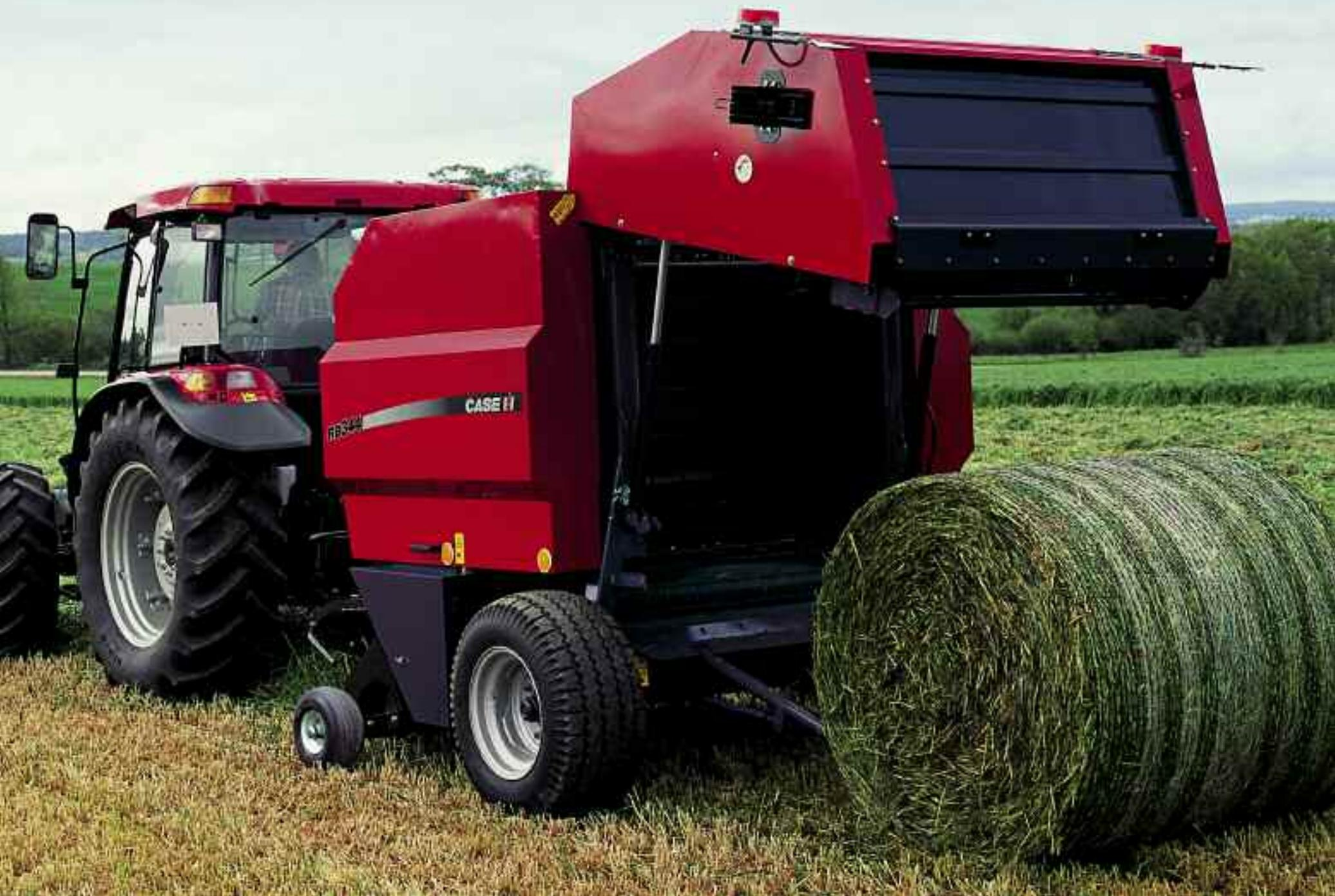
**Рулоны с идеальной структурой и поверхностью** Пружинная система управления плотностью натяжения обеспечивает высокое уплотнение материала и формирование рулонов безупречно правильной формы диаметром до 1.25 м.
