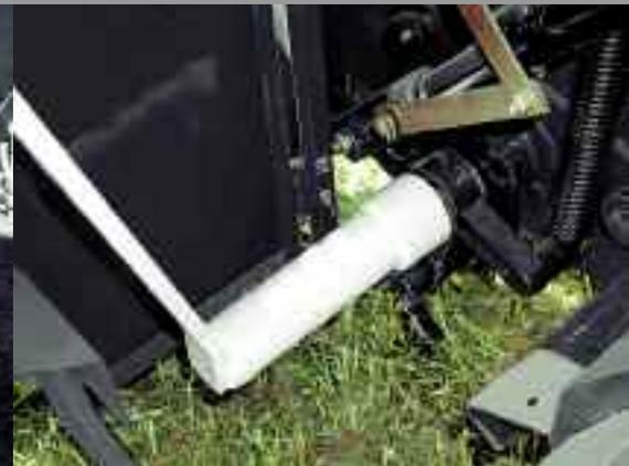
Высоконадежный опорный валец плавно, но уверенно сообщает рупону вращательное движение, одновременно принимая на себя его вес.
