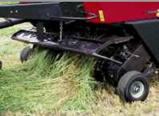
Возможность установки выносного ролика улучшает стабильность работы подборщика при уборке объемных валков и в ходе сенозаготовки.
