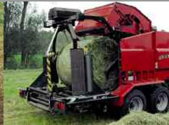
Подборщик с двухметровой шириной захвата обеспечивает эффективный подъем валка.
